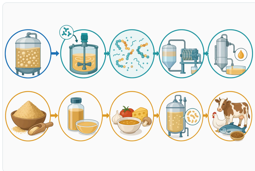
Figure 5. 受控的酵母水解流程串聯了漿液製備、酵素添加、反應控制、分離，以及後續濃縮或乾燥步驟。
