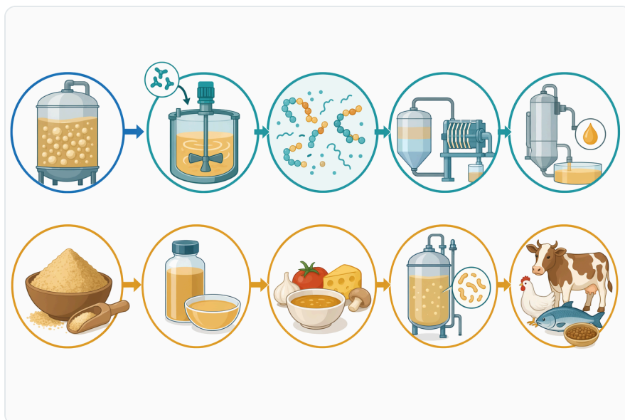
Figure 5. 제어된 효모 가수분해 공정은 슬러리 준비, 효소 첨가, 반응 제어, 분리, 그리고 후속 농축 또는 건조 단계를 연결합니다.
