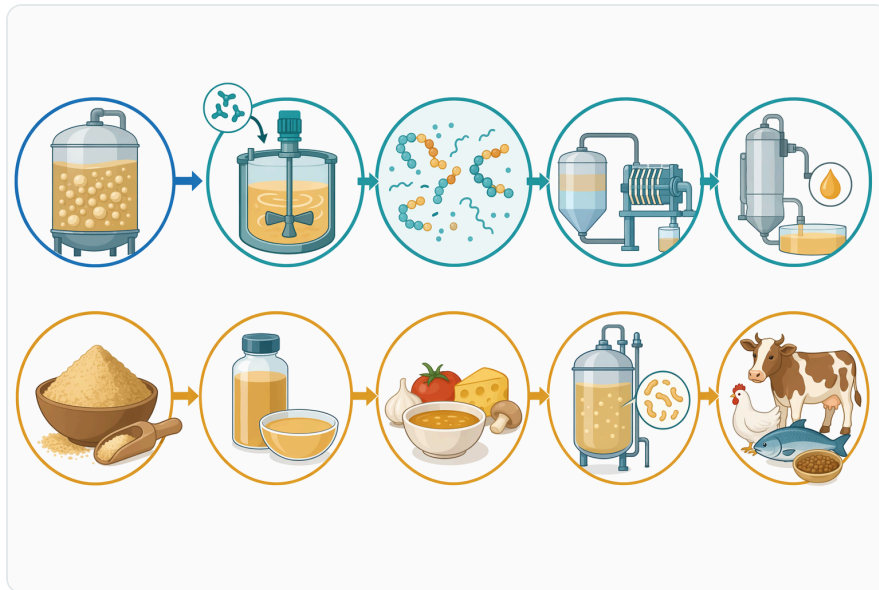
Figure 5. 제어된 효모 가수분해 공정은 슬러리 준비, 효소 첨가, 반응 제어, 분리, 후속 농축 또는 건조 단계를 연결한다.
