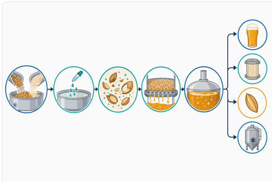
Figure 4. 木聚糖酶通常在糖化過程中添加，使半纖維素水解能在麥汁於過濾槽或醪液過濾機中分離之前發生。
