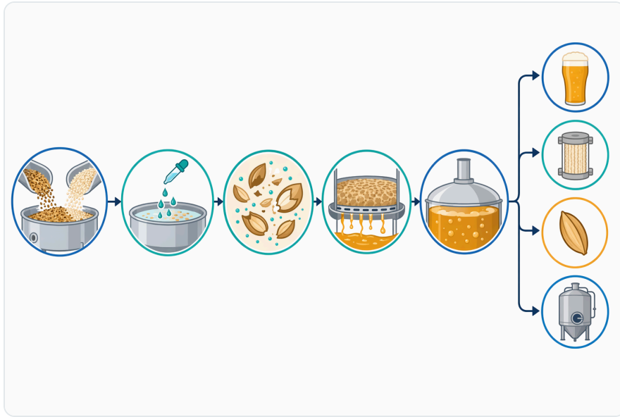
Figure 4. 자일라나아제는 일반적으로 매싱 단계에서 적용되어, 라우터 튜이나 매시 필터에서 맥즙을 분리하기 전에 헤미셀룰로스 가수분해가 일어나도록 한다.
