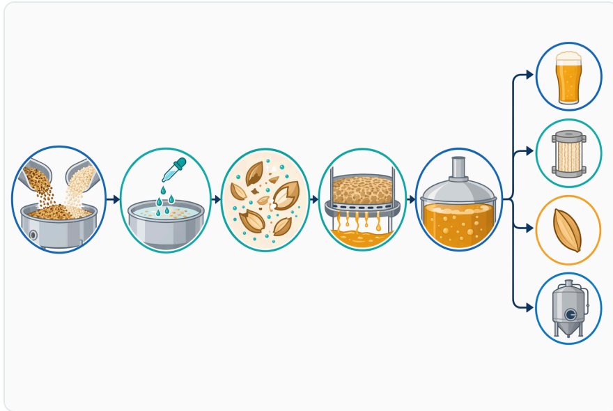
Figure 4. 자일라나아제는 보통 매싱 단계에서 적용되어, 라우터 튠이나 매시 필터에서 맥즙을 분리하기 전에 헤미셀룰로스 가수분해가 일어날 수 있게 한다.
