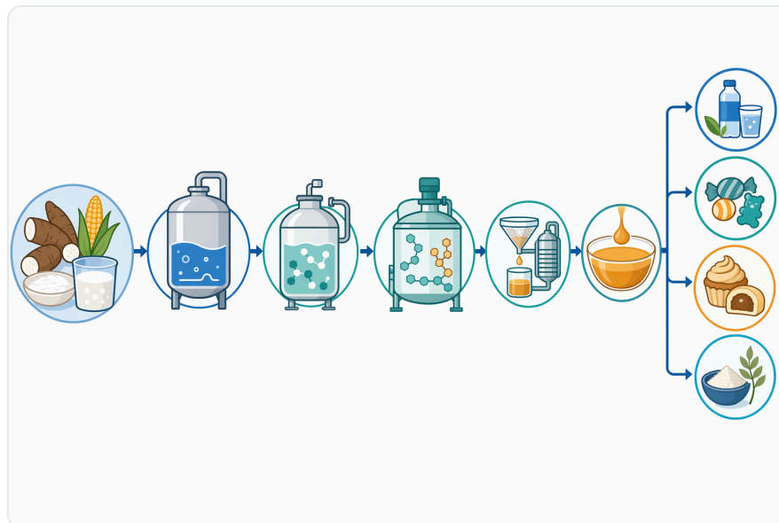
Figure 4. IMO 지향 공정은 일반적으로 전분이 풍부한 원료를 접근 가능한 맥아당 또는 덱스트린 기질로 전환한 뒤, 트랜스글루코시다아제가 혼합물을 \alpha -1,6 결합 올리고당 쪽으로 이동시키도록 한다.
