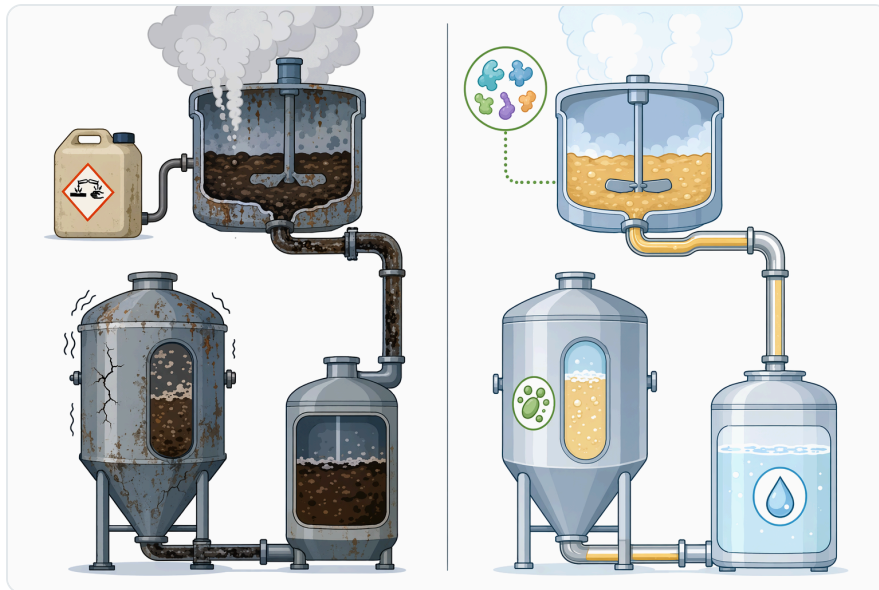
Figure 7. 澱粉基乙醇仰賴澱粉酶系統進行液化與糖化；木質纖維素乙醇則需要預處理以及纖維素酶或半纖維素酶系統。
