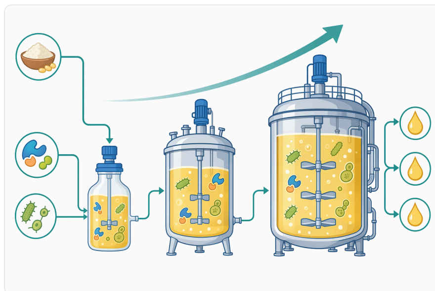
Figure 8. 발표된 전분-에탄올 연구에는 실험실 규모부터 파일럿 및 산업용 발효 조 규모까지 평가된 동시 가수분해 및 발효 공정이 포함된다.
