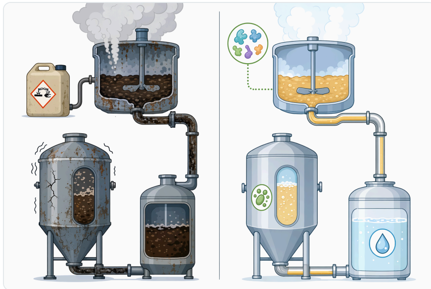
Figure 7. 전분 기반 에탄올은 아밀라아제 계열 효소에 의한 액화와 당화에 의존하는 반면, 리그노셀룰로오스 에탄올은 전처리와 셀룰라아제 또는 헤미셀룰라아제 시스템이 필요하다.
