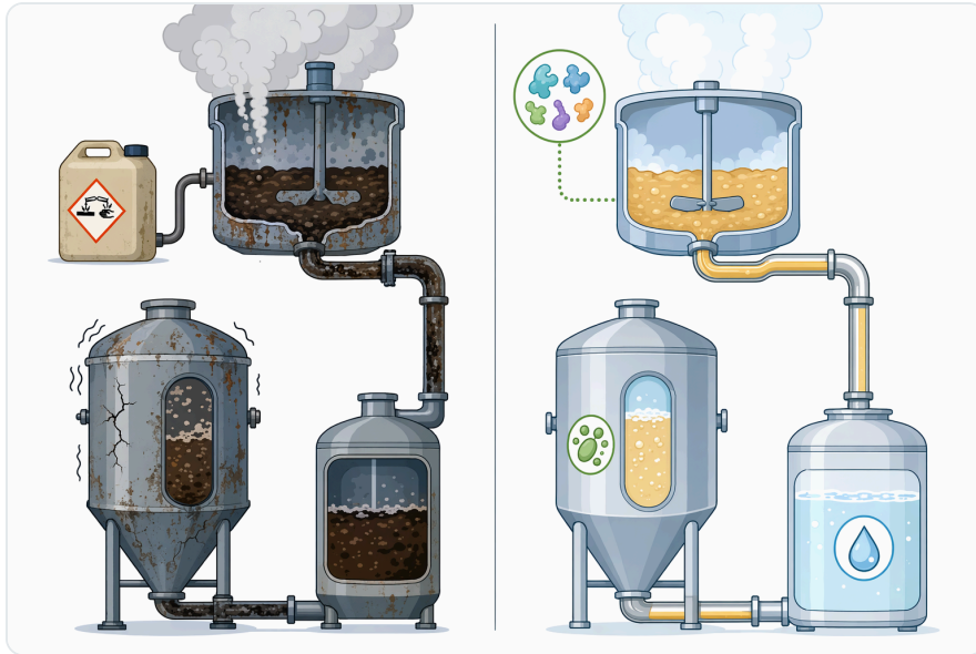
Figure 7. 전분 기반 에탄올은 아밀라아제계 효소에 의한 액화와 당화에 의존하는 반면, 리그노셀룰로오스 에탄올은 전처리와 셀룰라아제 또는 헤미셀룰라아제 시스템이 필요하다.
