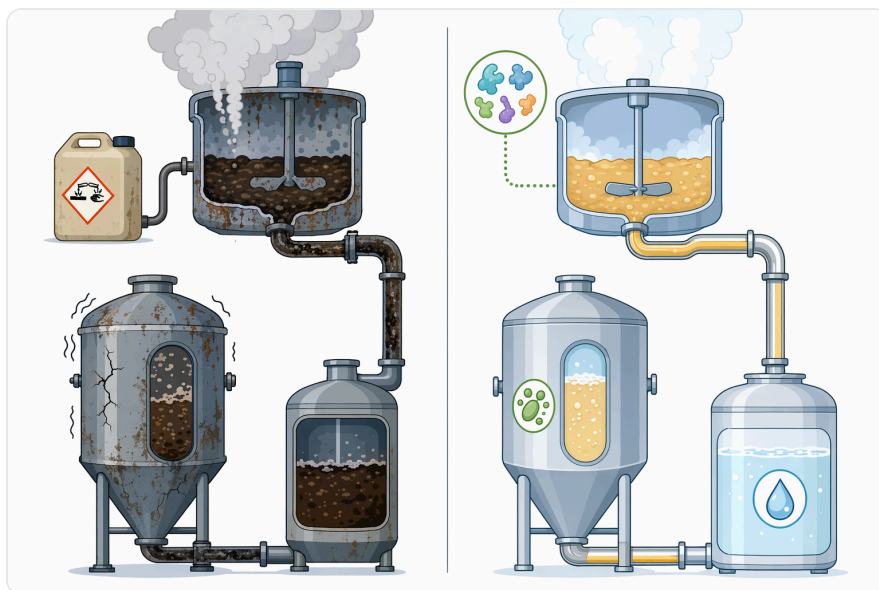
Figure 7. 전분 기반 에탄올은 아밀레이스계 액화와 당화에 의존하는 반면, 리그노셀룰로오스 기반 에탄올은 전처리와 셀룰레이스 또는 헤미셀룰레이스 효소 시스템이 필요하다.
