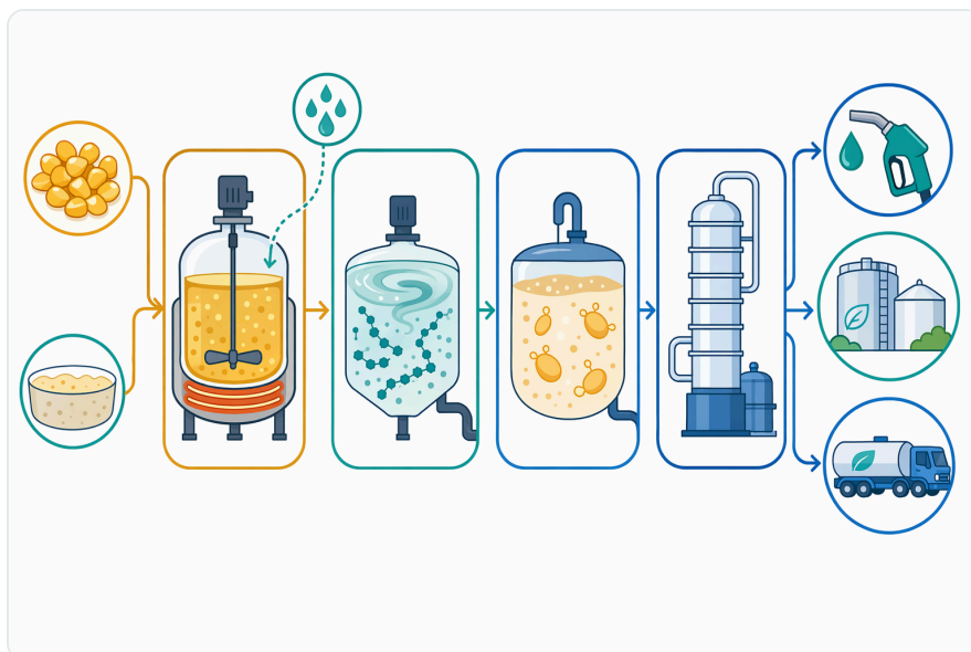
Figure 4. La production d'éthanol à partir d'amidon distingue la cuisson, la liquéfaction par l'alpha-amylase, la saccharification, la fermentation et la récupération de l'éthanol en étapes de procédé distinctes.
