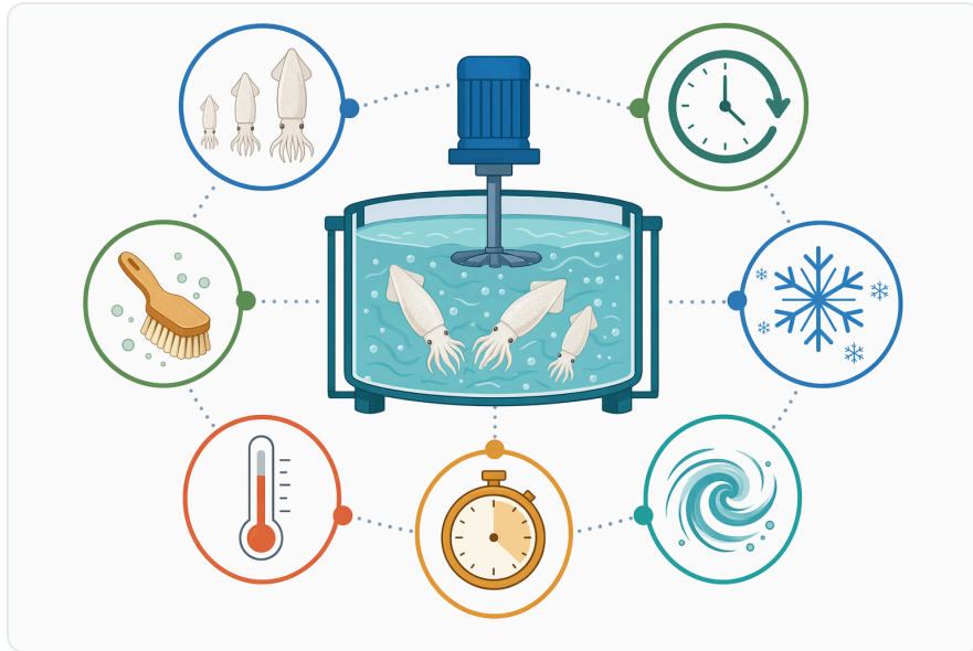
Figure 6. 去皮效果取決於原料差異，以及接觸均勻性、停留時間與溫度管理等受控產線條件。
