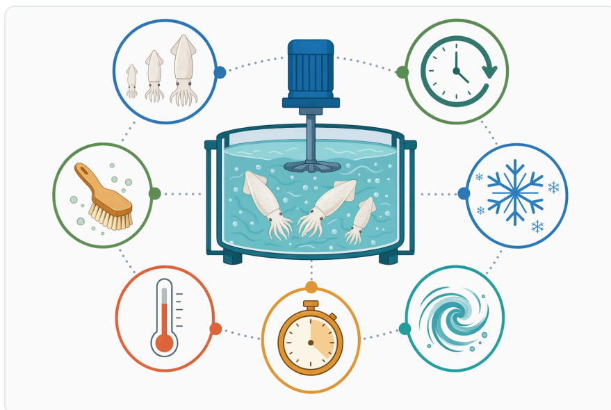
Figure 6. Hiệu quả lột da phụ thuộc vào sự biến động của nguyên liệu thô và các điều kiện dây chuyền được kiểm soát như độ đồng đều tiếp xúc, thời gian lưu và quản lý nhiệt độ.
