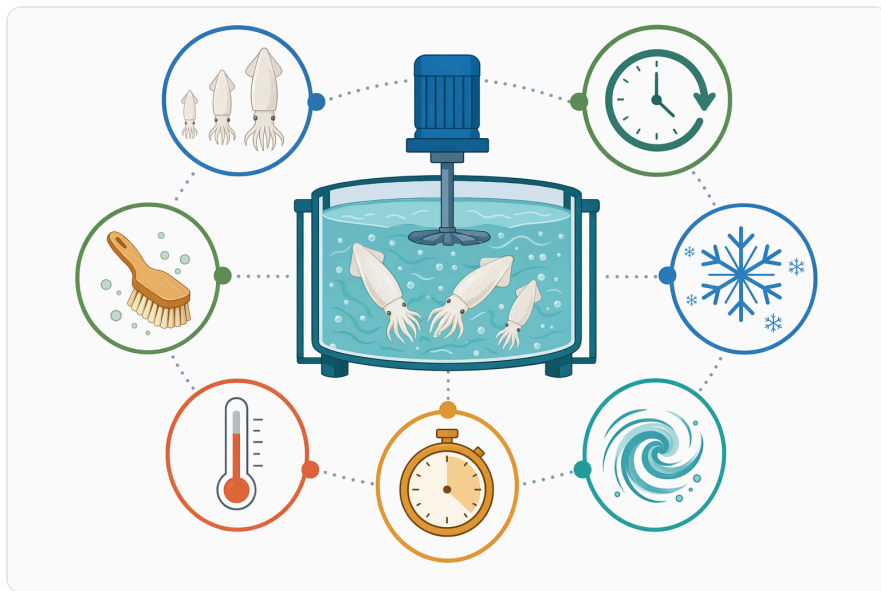
Figure 6. 박피 성능은 원료의 변동성과 접촉 균일성, 체류 시간, 온도 관리 같은 제어된 라인 조건에 따라 달라진다.
