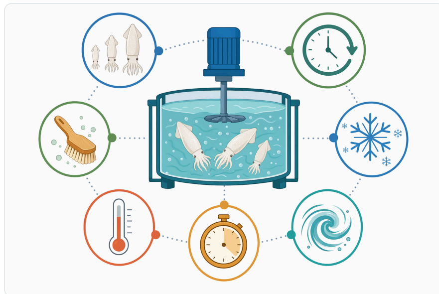
Figure 6. 박피 성능은 원료의 변동성과 접촉 균일성, 체류 시간, 온도 관리 같은 제어된 공정 조건에 따라 달라집니다.
