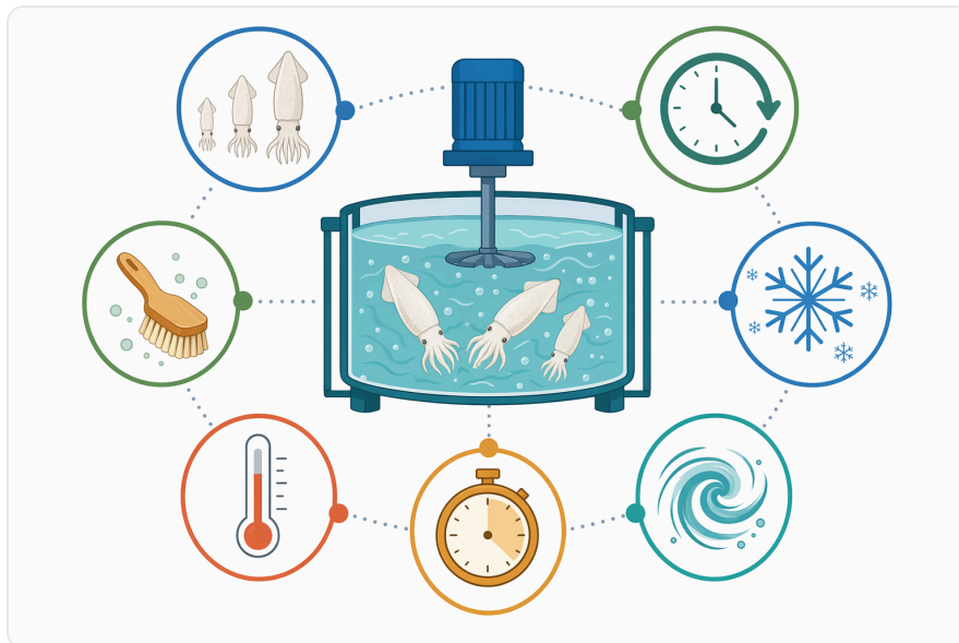
Figure 6. 박피 성능은 원료의 변동성과 접촉 균일성, 체류 시간, 온도 관리 등 제어된 라인 조건에 따라 달라집니다.
