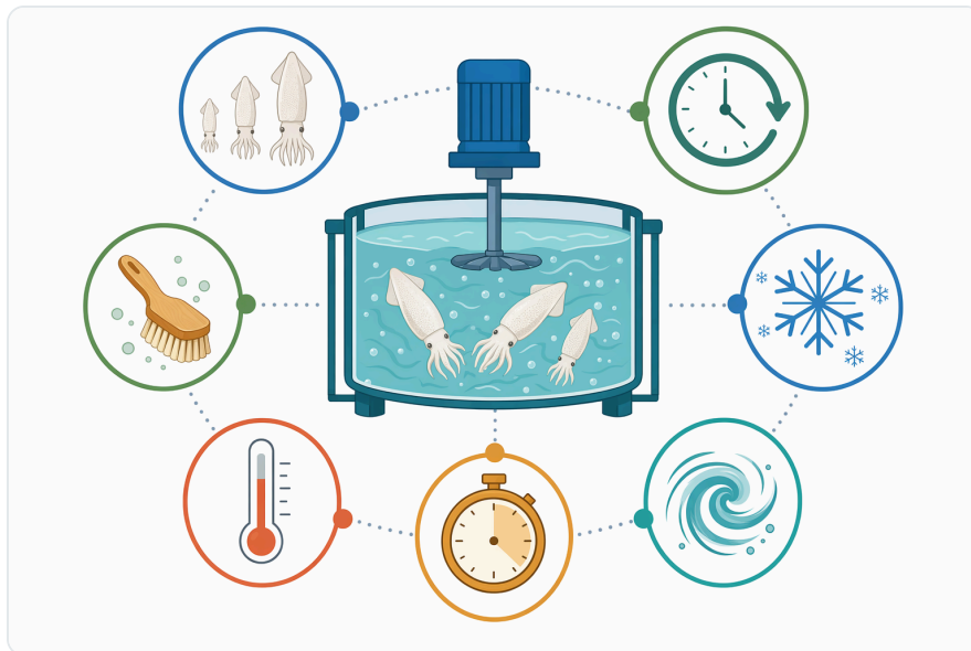
Figure 6. 박피 성능은 원료의 변동성과 접촉 균일성, 체류 시간, 온도 관리와 같은 제어된 라인 조건에 따라 달라집니다.
