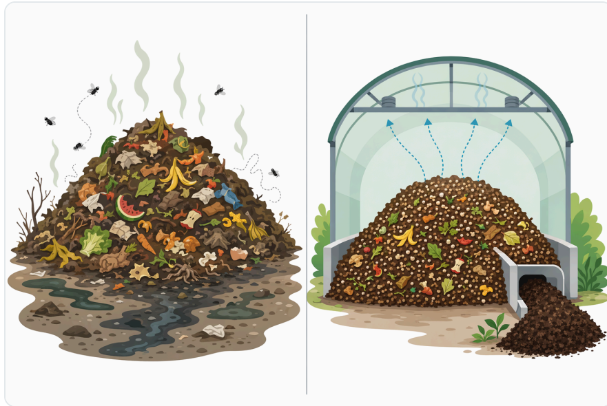
Figure 4. 與未經管理的棄置相比，微生物處理可加速有機物分解、降低臭味，並產生較穩定、類似堆肥的殘餘物。
