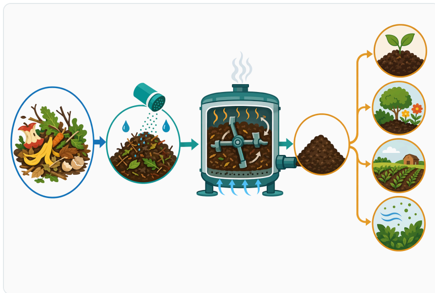
Figure 2. 고형 폐기물 세균 처리는 보통 습하고 공기가 공급되는 유기성 폐기물에 투입되어 안정화와 퇴비 형성을 촉진한다.
