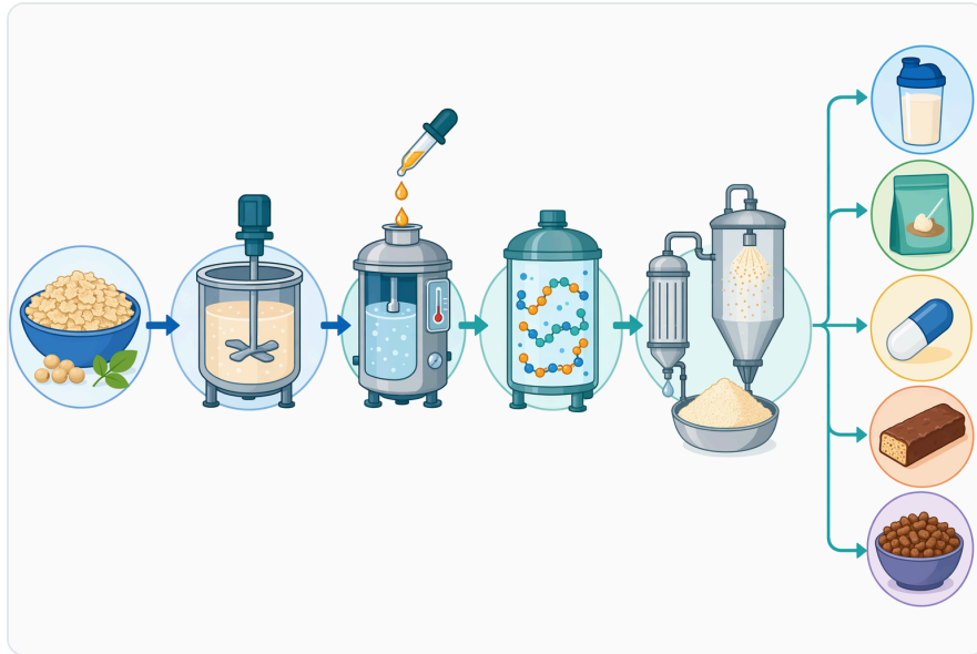
Figure 8. 受控的大豆胜肽製程通常包括分散基質、在適當條件下加入蛋白酶、終止水解，隨後澄清、濃縮、乾燥、混合或進一步加工水解物。
