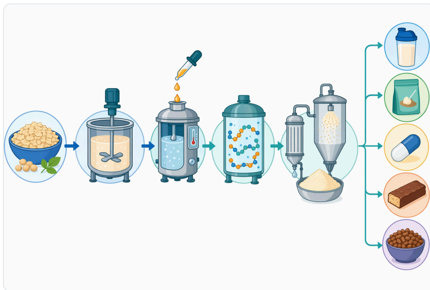
Figure 8. 제어된 대두 펩타이드 공정은 일반적으로 기질을 분산시키고, 적절한 조건에서 프로테아제를 첨가한 뒤, 가수분해를 중지하고, 이후 가수분해물을 정화, 농축, 건조, 혼합하거나 추가 가공하는 단계로 이루어진다.
