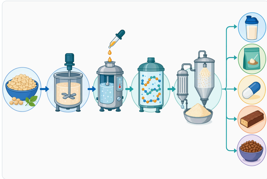
Figure 8. 제어된 대두 펩타이드 공정은 일반적으로 원료를 분산시키고, 적절한 조건에서 프로테아제를 첨가한 뒤, 가수분해를 중지하고, 이후 가수분해물을 정화, 농축, 건조, 혼합하거나 추가 가공하는 단계로 이루어진다.
