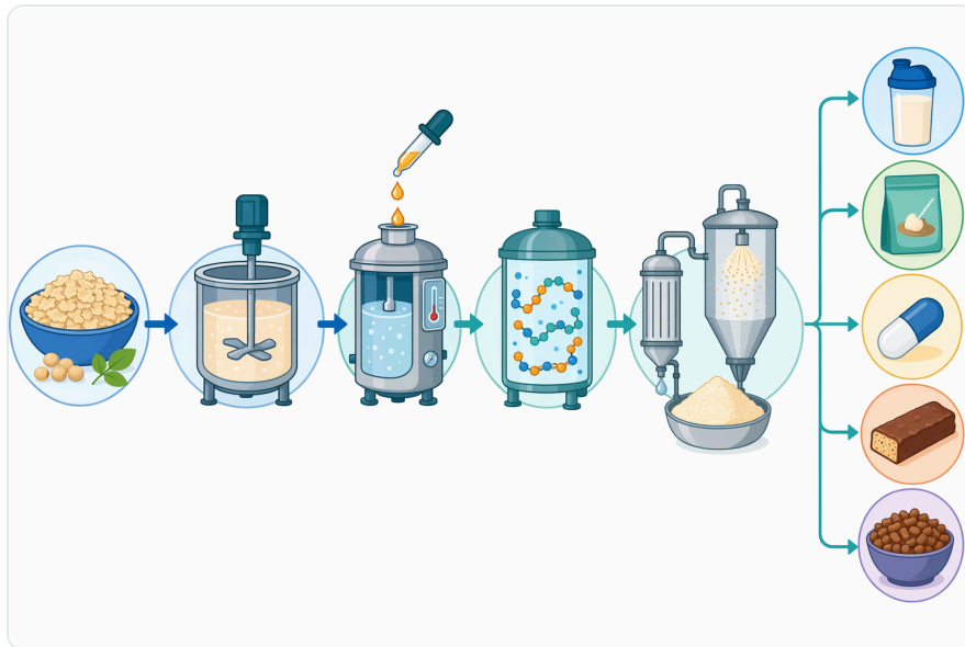
Figure 8. 제어된 대두 펩타이드 공정은 일반적으로 기질을 분산시키고, 적절한 조건에서 프로테아제를 첨가한 뒤, 가수분해를 중지하고 이후 가수분해물을 청징, 농축, 건조, 혼합하거나 추가 가공하는 단계로 이루어진다.
