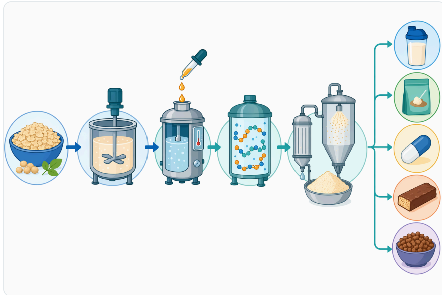
Figure 8. 제어된 대두 펩타이드 공정은 일반적으로 원료를 분산시키고, 적절한 조건에서 프로테아제를 첨가한 뒤, 가수분해를 중지하고, 이후 가수분해물을 정화, 농축, 건조, 배합하거나 추가 가공하는 단계로 이루어진다.
