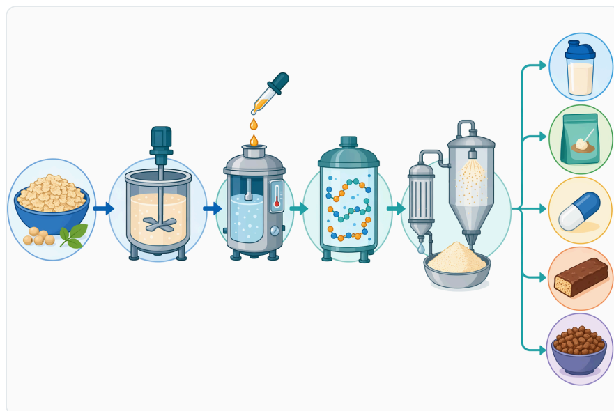
Figure 8. 제어된 대두 펩타이드 공정은 일반적으로 원료를 분산시키고, 적절한 조건에서 프로테아제를 첨가한 뒤, 가수분해를 중지하고, 이후 가수분해물을 정화, 농축, 건조, 배합하거나 추가 가공하는 과정으로 이루어진다.
