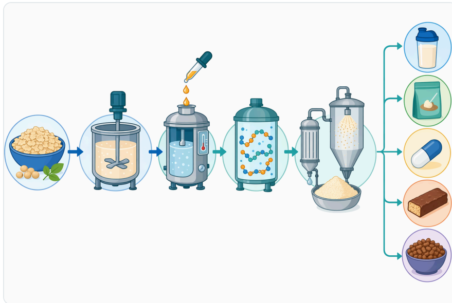
Figure 8. 일반적인 조절 대두 펩타이드 공정은 원료를 분산시키고, 적절한 조건에서 프로테아제를 첨가한 뒤, 가수분해를 중지하고, 이후 가수분해물을 정제, 농축, 건조, 배합하거나 추가 가공하는 단계로 이루어진다.
