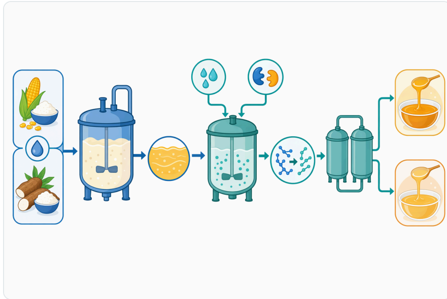
Figure 2. 전분당 공정에서 풀루라나아제는 일반적으로 호화와 액화 이후 단계에 투입되며, 이때 용해된 분지형 덱스트린이 탈분지와 당화에 이용될 수 있습니다.
