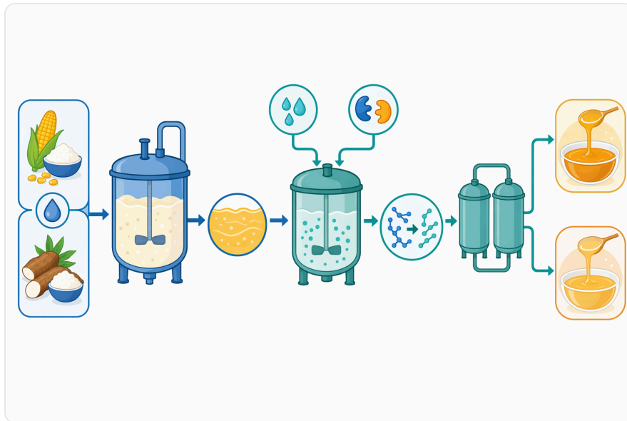
Figure 2. 전분 시럽 가공에서 풀룰라나아제는 일반적으로 호화 및 액화 단계 이후에 투입되며, 이때 용해된 분지형 덱스트린이 탈분지와 당화에 이용될 수 있습니다.
