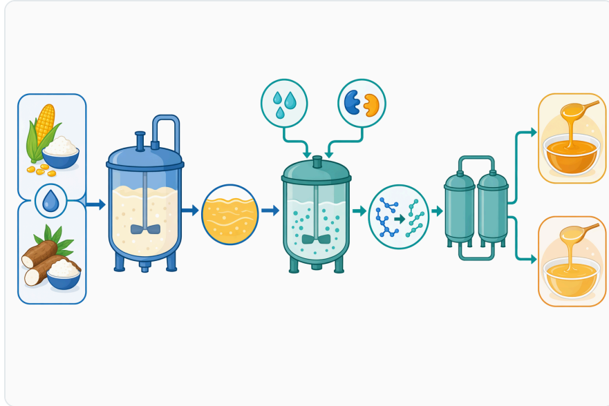
Figure 2. 전분당 시럽 공정에서 풀룰라나아제는 일반적으로 호화 및 액화 단계 이후에 투입되며, 이때 가용성 가지형 덱스트린이 탈분지와 당화에 이용될 수 있습니다
