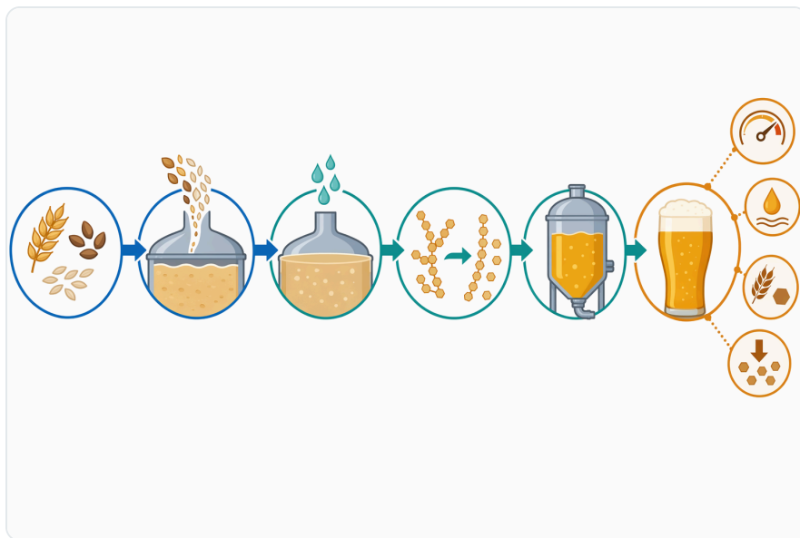
Figure 2. 전분 전환 과정이 체계적으로 진행될 때 \alpha -아밀라아제는 덱스트린을 만들고, 풀루라나아제는 분지 구조의 장벽을 제거하며, 당화 효소는 발효 가능한 당의 생성을 증가시킵니다.
