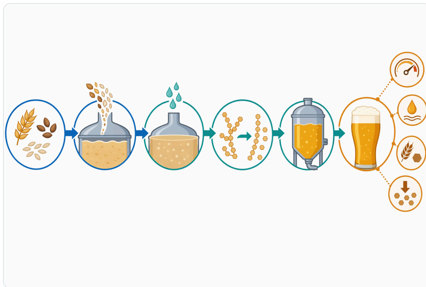
Figure 2. 전분 전환 과정이 유기적으로 진행될 때 \alpha -아밀라아제는 덱스트린을 만들고, 풀룰라나아제는 가지 구조의 장벽을 제거하며, 당화 효소는 발효 가능한 당의 생성을 늘린다.
