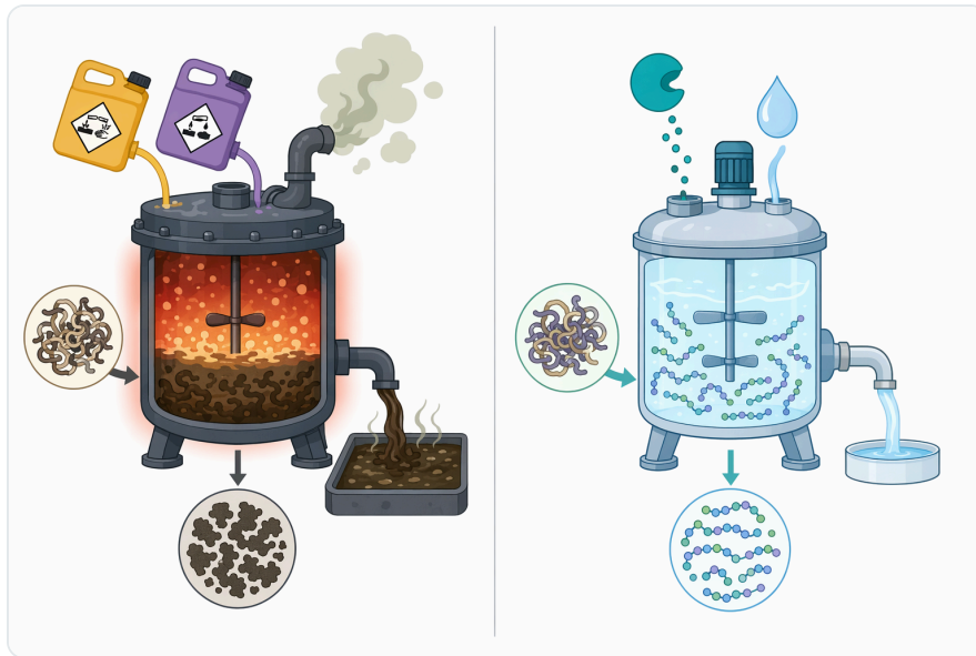
Figure 4. 與嚴苛的化學水解相比，中性蛋白酶可在較溫和且更可控的條件下分解蛋白質，並減少降解副產物。
