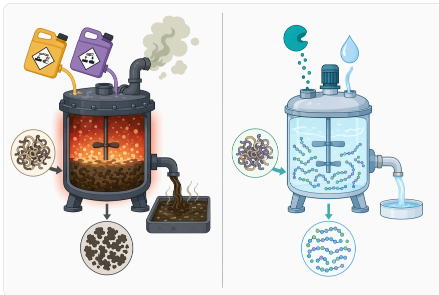
Figure 4. 강한 화학적 가수분해와 비교할 때, 중성 프로테아제는 더 온화하고 제어된 단백질 분해를 가능하게 하며 분해 부산물이 더 적습니다.
