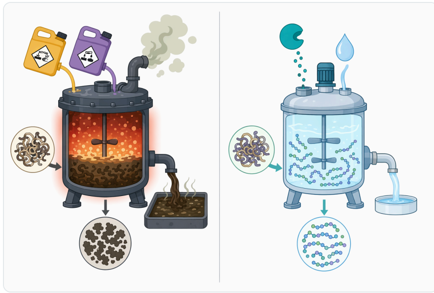
Figure 4. 강한 화학적 가수분해와 비교해, 중성 프로테아제는 더 온화하고 제어된 단백질 분해를 가능하게 하며 분해 부산물의 생성을 줄입니다
