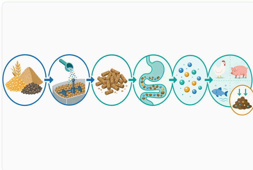
Figure 5. 효과적인 피타아제 작용에는 활성 효소, 접근 가능한 피테이트 기질, 충분한 수분, 적절한 pH, 그리고 충분한 접촉 시간이 필요합니다.
