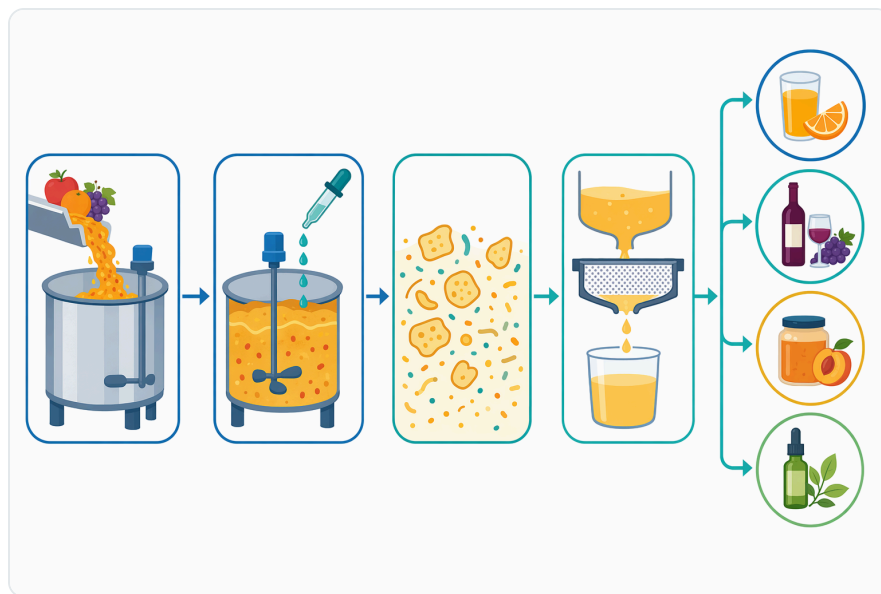
Figure 3. 在果汁萃取中，果膠酶通常在破碎或打漿後、壓榨、澄清、過濾或分離之前使用。
