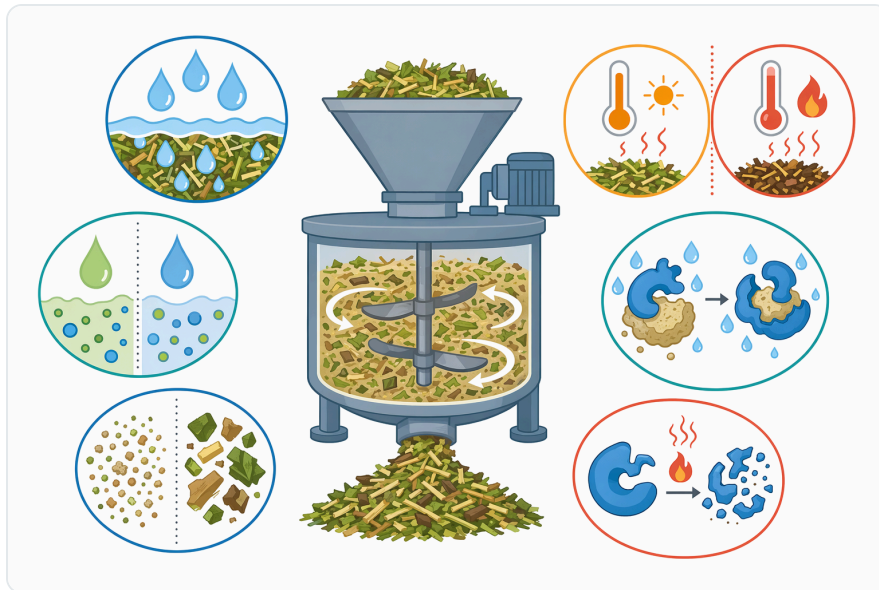
Figure 7. 수분, 열 노출, pH 환경, 입자 크기, 혼합 상태는 모두 펙티나아제가 펙틴과 접촉하고 기능을 유지할 수 있는지에 영향을 줍니다.
