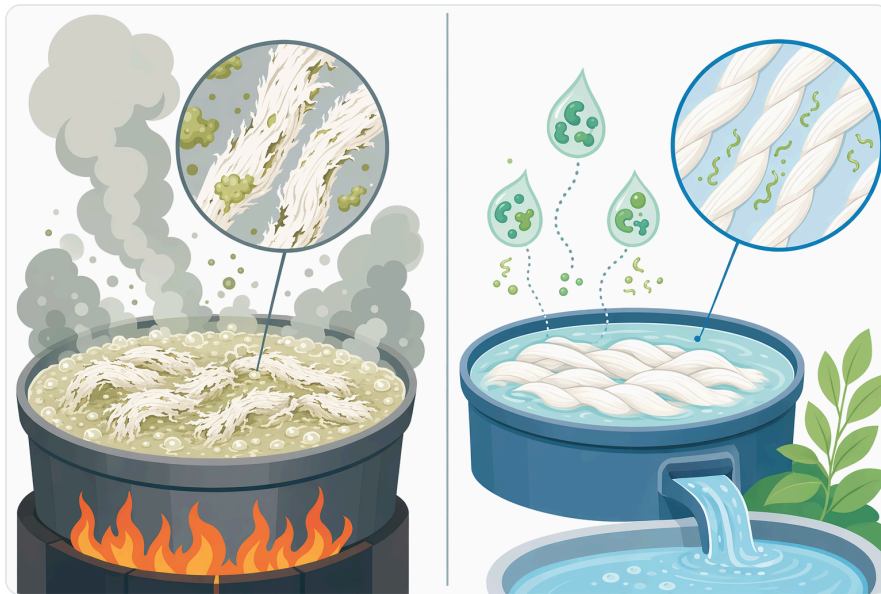
Figure 4. 與傳統鹼煮精練相比，果膠酸裂解酶生物精練可降低化學處理強度，同時保持纖維品質。
