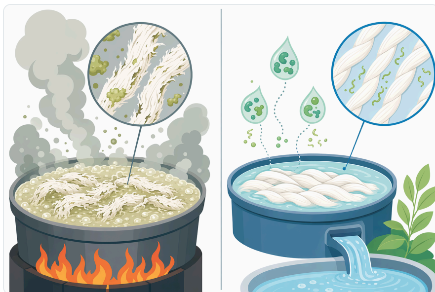
Figure 4. 기존의 알칼리 정련과 비교해, 펙테이트 라이아제를 이용한 바이오스 커링은 섬유 품질을 유지하면서 화학 처리 강도를 낮출 수 있다.
