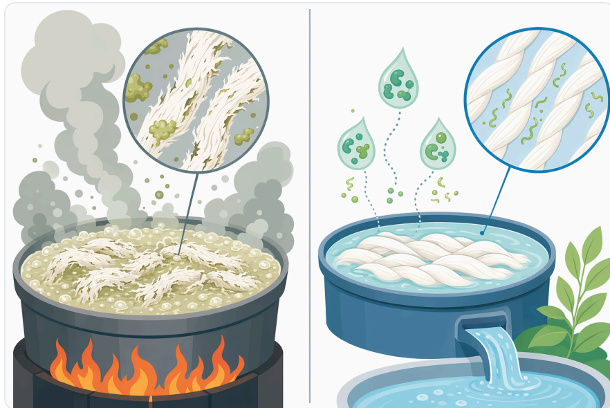
Figure 4. 기존의 알칼리 정련과 비교해, 펙테이트 라이아제를 이용한 바이오정련은 섬유 품질을 유지하면서 화학적 처리 강도를 낮출 수 있다.
