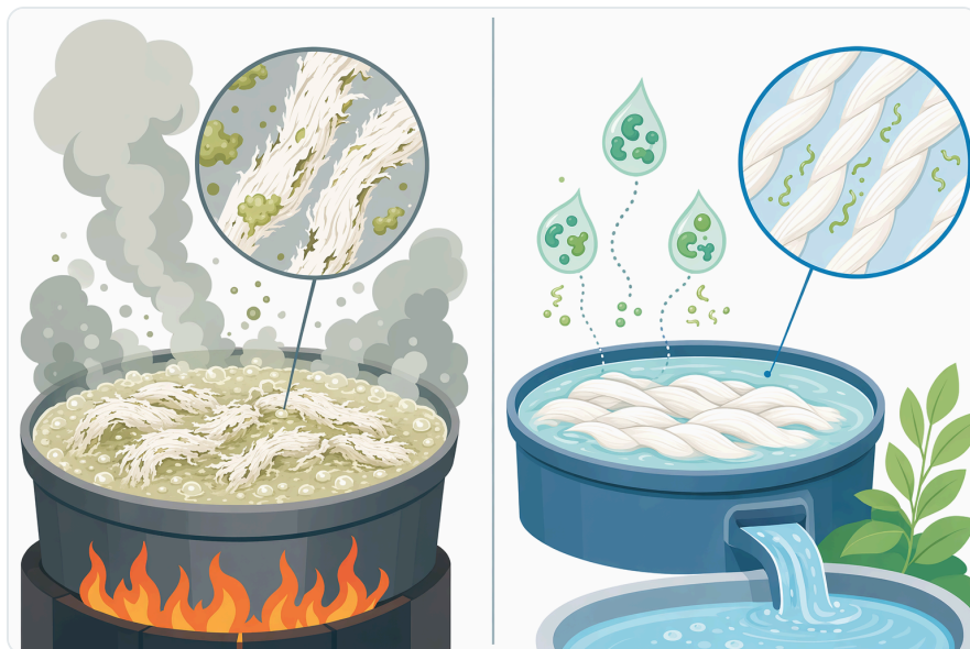
Figure 4. 기존의 알칼리성 스커링과 비교해, 펙테이트 라이아제를 이용한 바이오스커링은 섬유 품질을 유지하면서 화학적 처리 강도를 낮출 수 있다.
