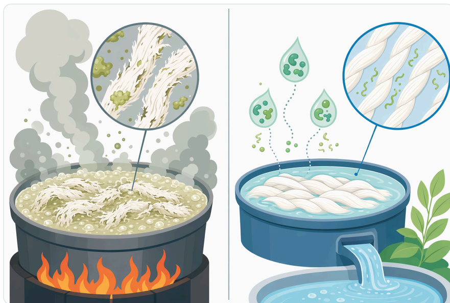
Figure 4. 기존의 알칼리 정련과 비교할 때, 펙테이트 라이아제를 이용한 바이오 정련은 섬유 품질을 유지하면서 화학 처리 강도를 낮출 수 있다.
