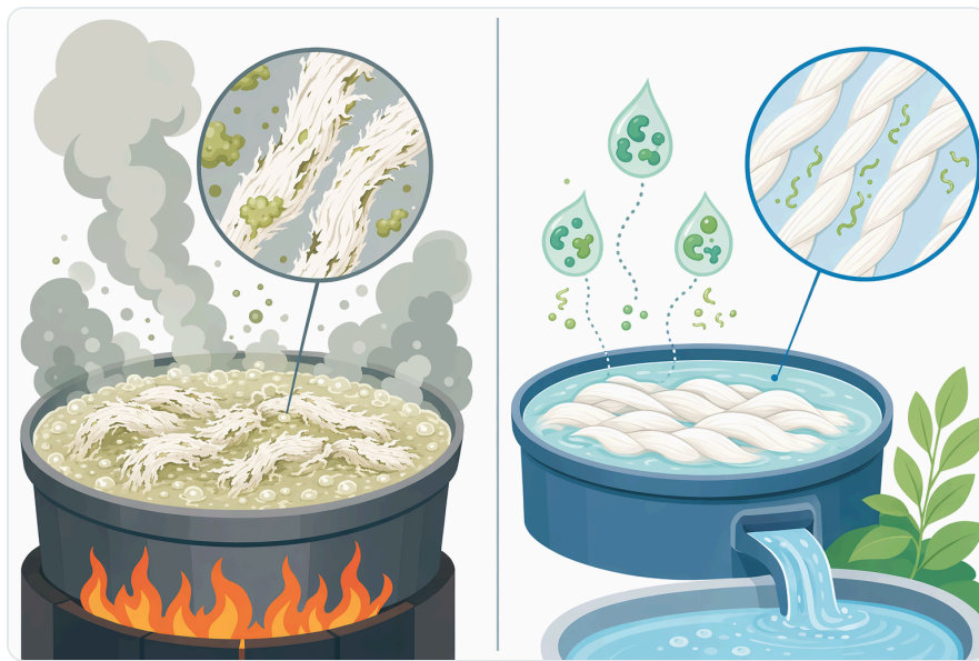
Figure 4. 기존의 알칼리 정련과 비교할 때, 펙테이트 분해효소를 이용한 바이오 정련은 섬유 품질을 보존하면서 화학적 처리 강도를 낮출 수 있다.
