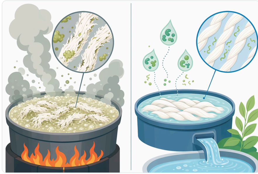
Figure 4. 기존의 알칼리 정련과 비교해, 펙테이트 분해효소를 이용한 바이오 정련은 섬유 품질을 보존하면서 화학적 처리 강도를 낮출 수 있다
