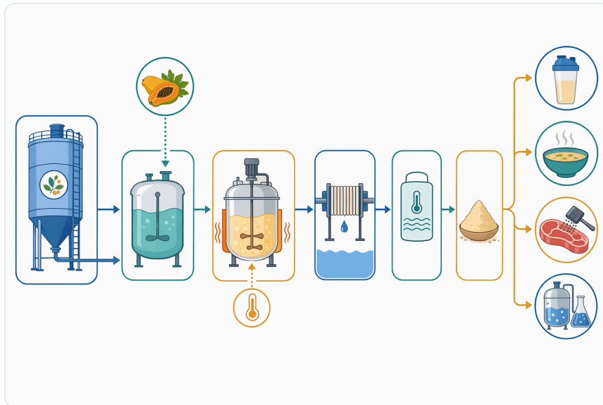
Figure 5. 在膠原蛋白與明膠加工中，受控的木瓜蛋白酶處理有助於在萃取與後續分離前打開皮料或修邊料的結構。
