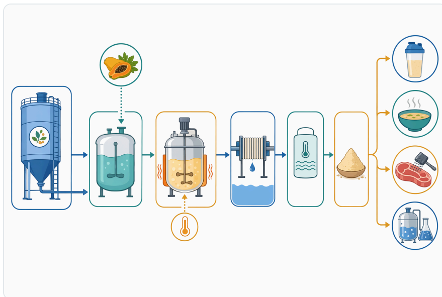
Figure 5. 콜라겐 및 젤라틴 가공에서 파파인에 대한 제어된 노출은 추출과 후속 분리 전에 가죽이나 절단 잔여물을 풀어 주는 데 도움이 된다.
