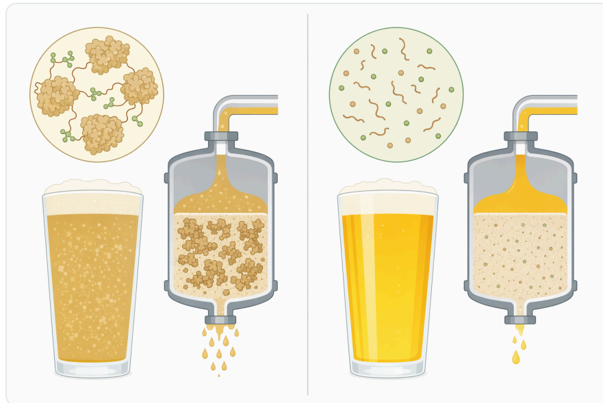
Figure 4. 파파인은 식물 유래의 광범위한 단백질 분해 작용을 제공하는 반면, 프롤린 특이적 엔도프로테아제와 비효소적 흡착제는 서로 다른 표적 선택성이나 제거 메커니즘을 통해 맥주의 안정성을 개선합니다.
