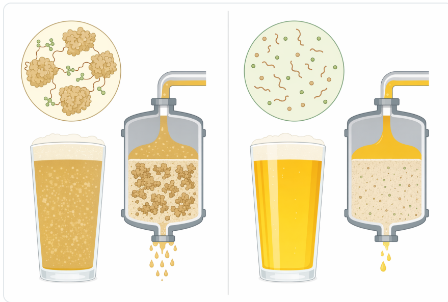
Figure 4. 파파인은 식물 유래의 폭넓은 단백질 분해 작용을 제공하는 반면, 프롤린 특이적 엔도프로테아제와 비효소적 흡착제는 서로 다른 표적 선택성이나 제거 메커니즘을 통해 맥주의 안정성을 개선한다
