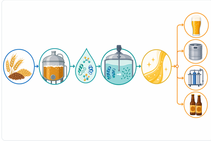
Figure 3. 파파인은 단백질 가수분해가 이후의 청징과 최종 안정성 확보에도움이 되도록 여과 또는 포장 전에 투입하는 것이 가장 논리적이다
