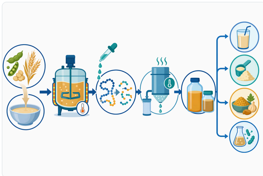
Figure 7. 일반적인 파파인 가수분해 공정은 식물성 단백질을 수화하고, 효소를 첨가한 뒤, 접촉 시간을 조절하고, 반응을 비활성화한 다음, 가수분해물을 혼합, 가열, 건조 또는 제형화하는 단계로 이루어집니다.
